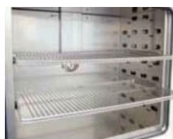
キャビネット型乾燥炉に使用する装入トレイは異なるレベルで引出し可能
