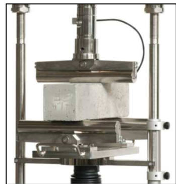
70-T0108/1 コンクリート曲げ試験
