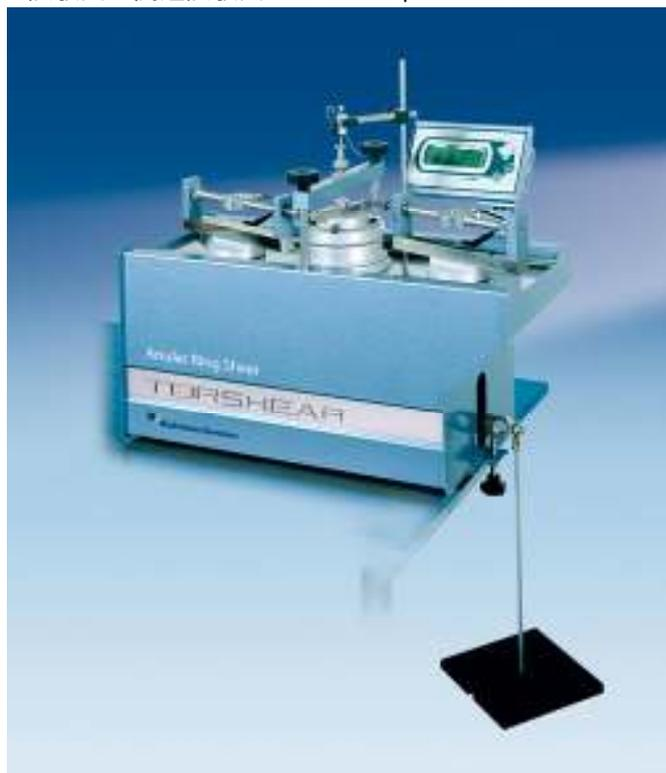
大きく変位する地すべりの平面破壊や断層の際にせん断する土質の強度を測定できます。
