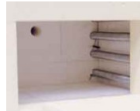
炉内壁の高品質耐火レンガ断熱
