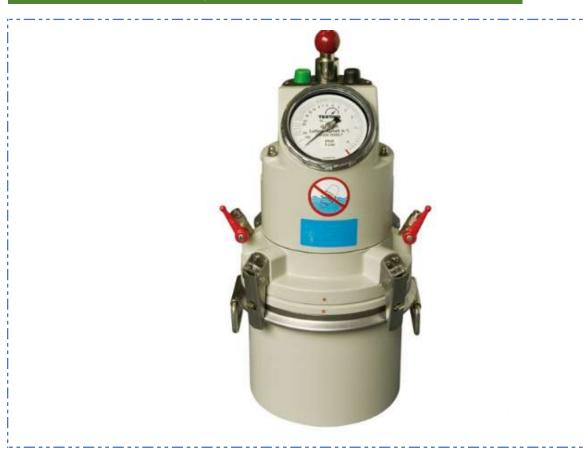
手動ポンプ式、フレッシュ混合モルタル用の試験装置です。
