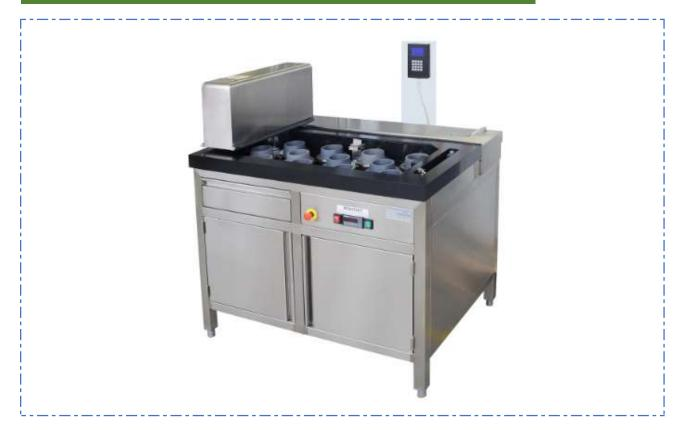
12か所の測定点で、全自動ビカー針試験を行う事が出来ます。 試験規格 EN 196-3、EN 480-2
