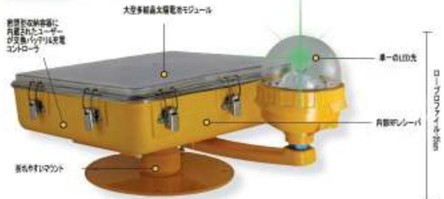
Avliteのヘリポートライトは、ソーラー式発電、ワイヤレスや完全に自律型のLEDヘリポートライトであり、ICAO付属書14の着陸&離昇地域境界線ライトの基準や視界気象条件下でのヘリポート境界線ライトFAA技術概要87を満たすように設計されます。
