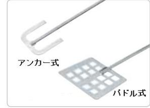
強い接線流攪拌にて、上下のサンプルを攪拌・せん断。粘度の高いサンプルの低・中速回転に適します。
