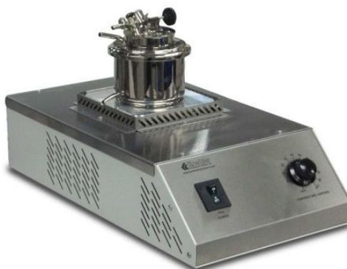
加熱は、目盛ダイヤルノブで調整します。繰り返し試験をする際に目盛によって設定が容易です。電気ヒーターの代わりにガスバーナーの使用も可能です。試料カップ蓋は可動板を開閉し、試験炎を試料へ導入します。あふれ口を持つ液浴槽、黄銅製試料カップ、温度計差込管、標準球で構成されています。
