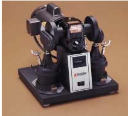
混和器はねじ切りされたカップとカバー、ドライブユニットに接続されるシャフトとハンドルが付属するプランジャープレートを含みます。ダイヤル温度計は通気弁に挿入されます。ねじクランプで混和器を固定し、試験後には取り外しが可能です。
