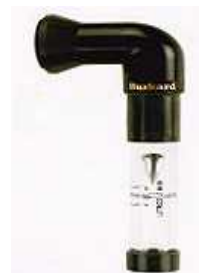
採集口でのスルーブットを測定する流量計
