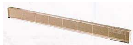
毎時/日サンプル採集のためのメリネックステープ区分用パースペックス(ポリマタクリル酸メチル)カットブロック
