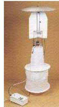
ライト下の小型モーターにより、捕獲物を着脱可能な布バッグに導きます。布バッグには、トラップを空にするスリット状の大きな裂け目があります。布バッグ底の、吸取紙付きの湿ったコットンウールの詰め物の使用により、捕獲物を生きたまま捕らえやすくなっています。
