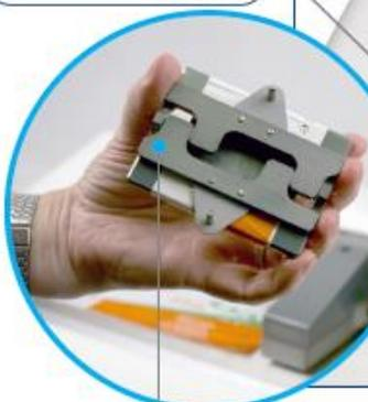
マグネットキャッチがサンプル端を素早く確実に握み、サンプル表面に触れるリスクを最小限に抑えます
