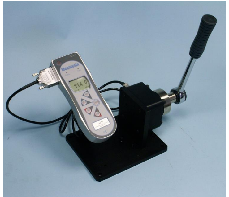
写真：機械式トルクレンチを試すTWC
