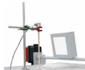
排気弁およびスタンド付きやチャージ熱電対は追加装備
