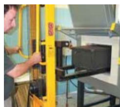
保護ガス雰囲気用のガス化ボックスのチャージ台車による作業
