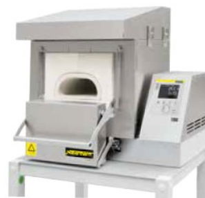
ラボラトリー溶銑炉(キューポラ)としての 029A4/13 CUP
