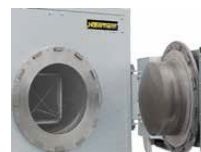
レトルト用差し込み式クイックロック、 電動式も追加装備で可能
