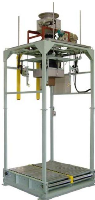
デジタルスケールの上に投入装置を搭載したタイプです。
