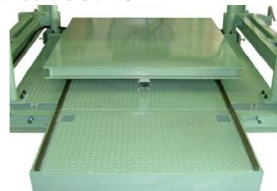
エアシリンダにより袋が載ったパレットを前に押し出します。袋が半分前に出る事により、フォークリフト等での取り出しを容易にします。シンプルで軽量な為、吊下げ式にも搭載可能です。
