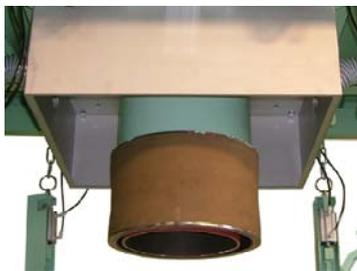
投入口全周貼り付けられたゴムホースが、エア投入により膨張する事で袋口をシールします。膨張幅が直径で約200mmなので、袋口のサイズが制限されますが、気密性が高く、簡単で確実なシールが行えます。
