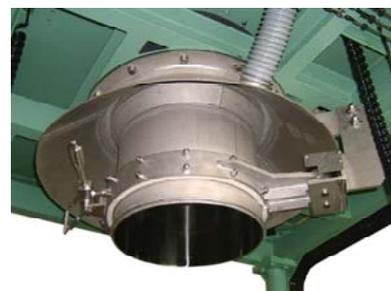
半円形のクランプを両側から押さえ付ける事で袋口をシールします。ロサイズの異なる袋にある程度対応が可能なので、取り扱う袋の種類が多い場合等に適しています。
